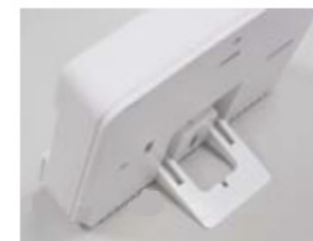
3. Coloque el soporte haciendo tope con la parte inferior y encastrado en las trabas del transmisor.
